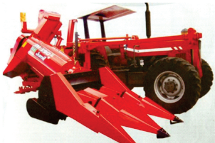
Cosechadora de maíz que también puede adaptarse para cosechar el frijol y otras leguminosas
