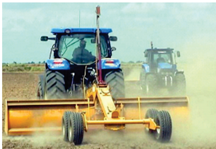
Un equipo nivelador usando información satelital.
